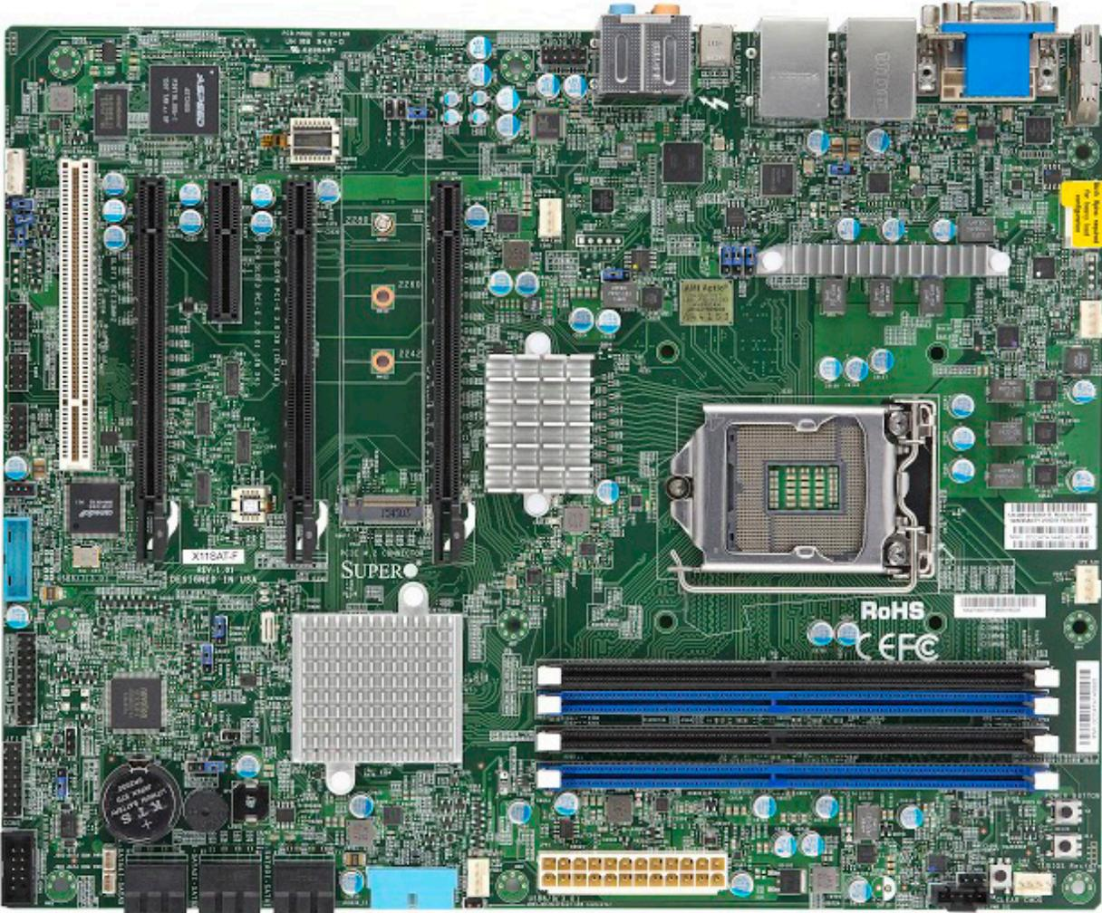
**Figure 1-3. X11SAT/X11SAT-F Motherboard Layout**
